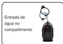
**5.** Antes de iniciar, primeiramente gire a pá do ventilador para checar se a bomba pode ser operada flexivelmente; Então retire a tampa do compartimento de água, encha a bomba com água potável e aguarde o ar de dentro da
