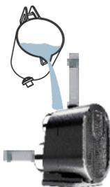
3. Caso a bomba não seja utilizada por um longo tempo, drene a água da bomba, limpe as peças da bomba, como rotor, bracket e corpo da bomba. Aplique óleo anti-corrosivo e armazene-a em local seco e ventilado.
